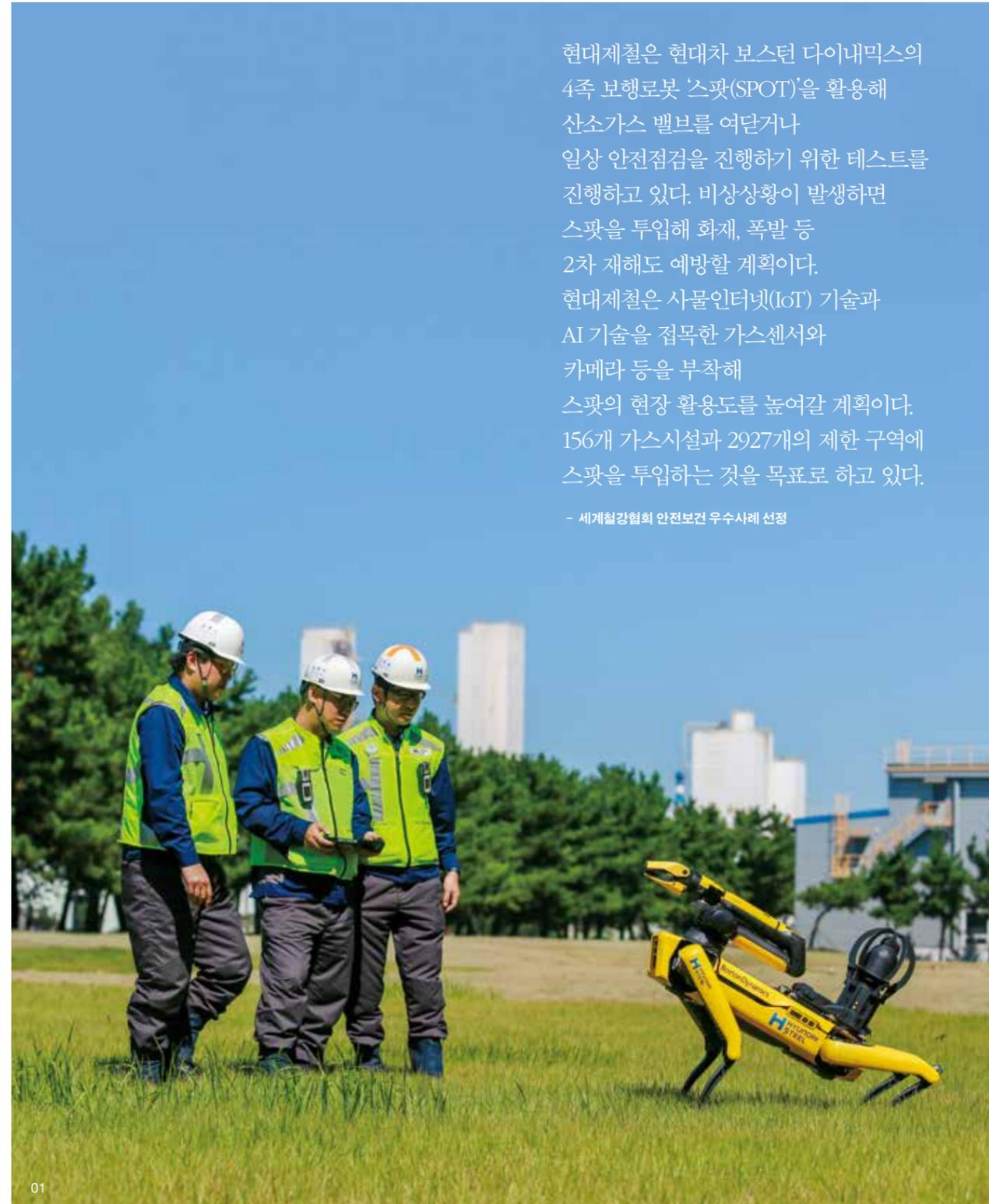
현대제철은 현대차 보스턴 다이내믹스의 4족 보행로봇 '스팟(SPOT)'을 활용해 산소가스 밸브를 여닫거나 일상 안전점검을 진행하기 위한 테스트를 진행하고 있다. 비상상황이 발생하면 스팟을 투입해 화재, 폭발 등 2차 재해도 예방할 계획이다. 현대제철은 사물인터넷(IoT) 기술과 AI 기술을 접목한 가스센서와 카메라 등을 부착해 스팟의 현장 활용도를 높여갈 계획이다. 156개 가스시설과 2927개의 제한 구역에 스팟을 투입하는 것을 목표로 하고 있다.
